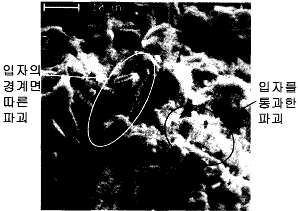
그림 10. 입자의 경계면 및 입자를 통과한 진행을 보이는 날개크랙의 표면
