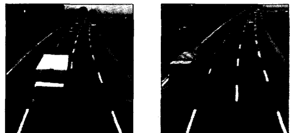
(a) 그림자가 통과하는 경우 (b) 검은색 차량이 통과하는 경우 (그림 7) 그림자와 검은색 차량의 구별
