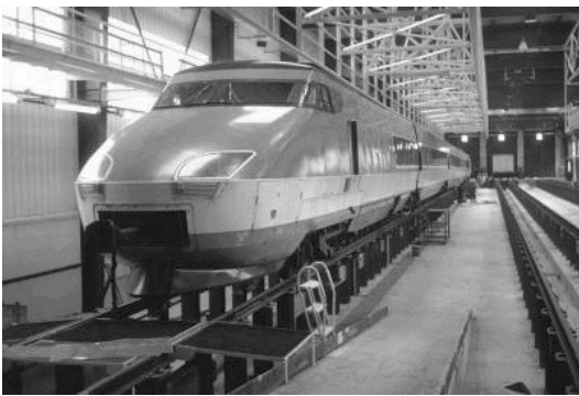
그림 6. 프랑스의 가스터빈 구동 고속열차 TGV-001
