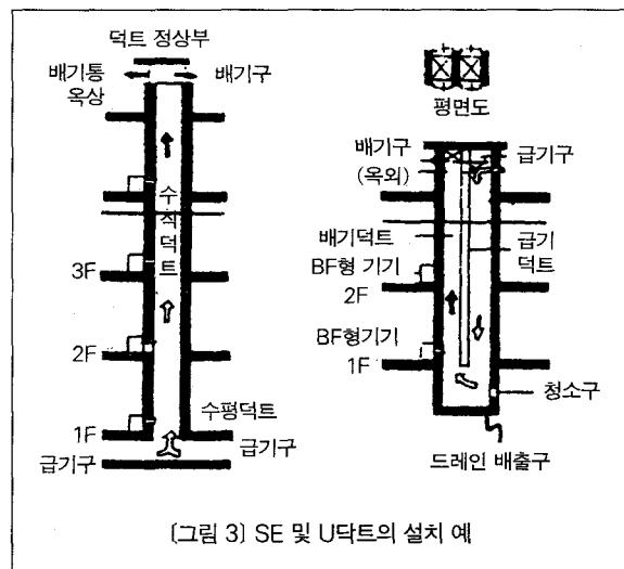
[그림 3] SE 및 U-닥트의 설치 예
