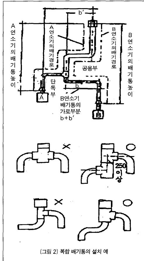
[그림 2] 복합 배기통의 설치 예
