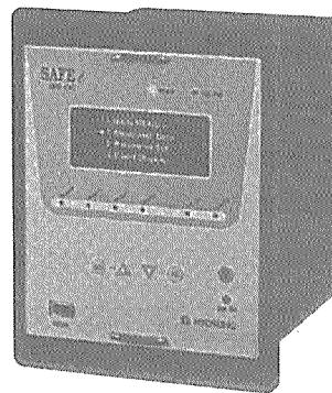
럼 철저한 설계와 시험을 통해 첫선을 보이게 된 HPR-OC는 한전의 25.8kV급 C-GIS뿐만 아니라 다양한 배전반에 적용이 가능하다. 특히 HPR-OC는 최신의 계전 알고리즘과 마이크로 프로세서 기술을 접목하여 기존의 아날로그 보호계전기에 비해 조작의 편리성 및 유지 보수의 용이함을 제공하고, 수배전반에서 사용되는 계측기기와 보호계전 기능을 하나로 집약하였으며, 고장 데이터와 각종 이벤트의 저장능력과 통신기능을 제공하고 있다.
