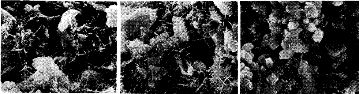
<사진 1> A-시멘트 경화체의 주사전자현미경 사진(수화 3일, 10, 20, 30℃ 양생)
