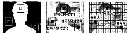
(a)이전 영상 마스크 (b) 이전 영상 (c) 현재 영상 그림 14 마스크 영상을 이용한 선택적 움직임 추적 Fig. 14 An optional motion estimation using mask image
