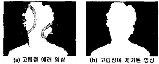
그림 16 메디안 필터를 사용하여 고립점 제거 Fig. 16 Removal of error pixels by using Median filter
