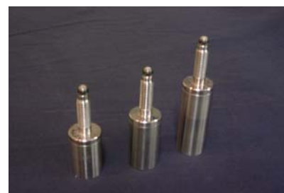
그림 5. 압전진동자의 적층수에 따라 제작된 초음파센서
