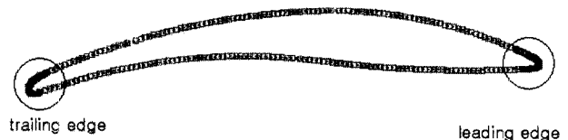
그림 4. 3차원 측정기를 이용한 에어포일 측정점.
