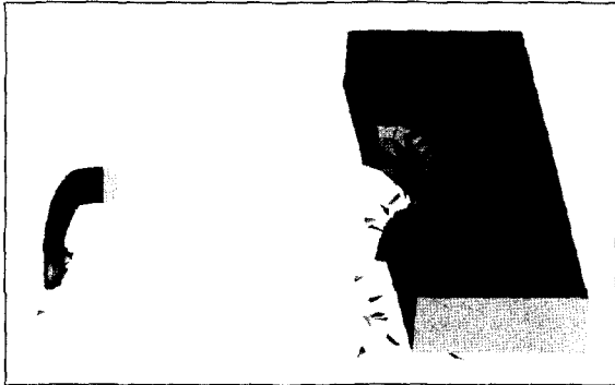
[그림 4] 긴 관통자의 정지 경사판재(탄속 2.5 km/s, 경사각 60°) 최종 관통 형상
