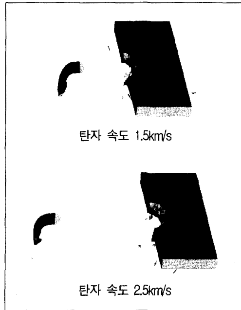
[그림 14] 긴 관통자의 정지 경사판재(경사각 60°) 최종 관통 형상
