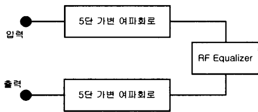
그림 5. 12단 가변대역통과 여파기의 구조도
