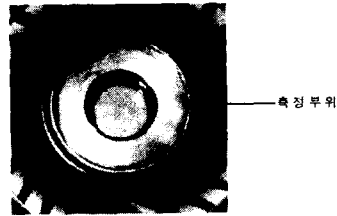
<그림6> 토크컨버터의 검사 부위 상세도
