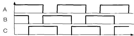
그림 3 3상 TSRM의 스위칭 타임차트 Fig. 3 Gating sequence of the 3 phase toroidal switched reluctance motor
