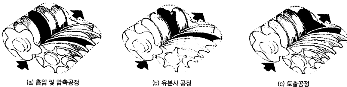
[그림 8] 압축기본체(Air End)의 압축원리
