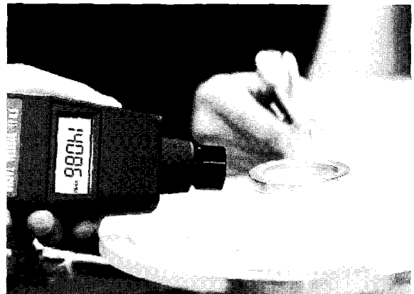
그림 4. 초전도체에서 부상해서 고속으로 회전하는 고리형 자석 회전체
