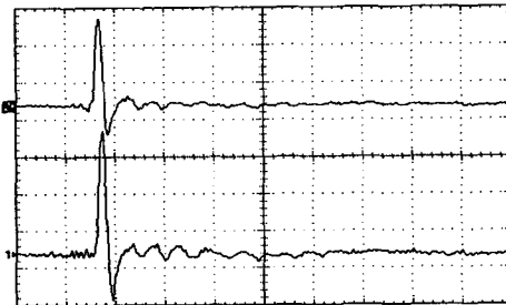
위 전류파형 : 20 A/div, 10 ns/div 아래 전압파형 : 640 V/div, 10 ns/div (a) 빠른 접근
