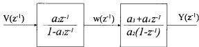
그림 5. 이산시간 영역에서 직류 서보 전동기의 구성도 Fig 5. Block diagram of the DC servo motor in the discrete-time domain
