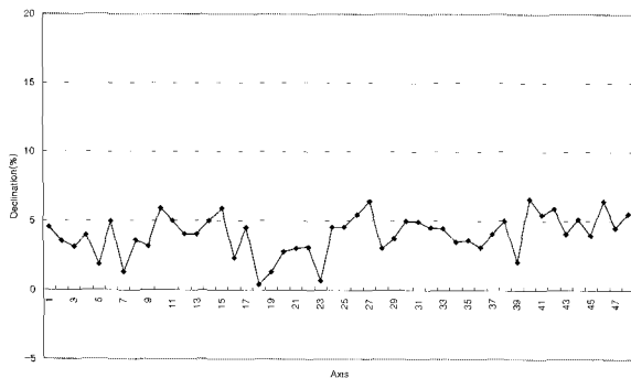
〈그림 16〉 인장응력 도입 완료 후 계산값과 계측값의 차이
