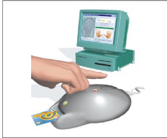
(그림 6) Match-on-Card 시스템(Oberthur Card System사)
