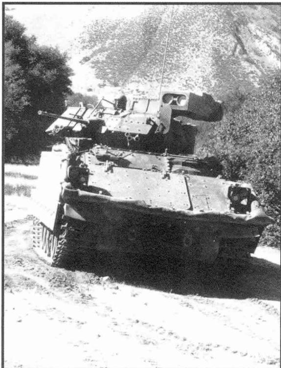
길이 : 30.96피트, 폭 : 장갑판 장착시 17.04피트, 장갑 스커트 장착시 15.48피트, 높이 : 14.04피트, 무게 : 전투 장비 장착시 67,000파운드, 동력원 : GM-Allison사에서 제작한 VTA-903T 600마력 디젤엔진, 순항거리 : 250마일, 속도 : 38마일/시간, 승무원수 : 9명(3명+보병6명), 탑재무기 : 25밀리 기관포, TOW II 미사일, 7.62밀리 M240C 기관총이 장비는 기갑/보병 여단, 포병 연대에 배치되어 있다.
