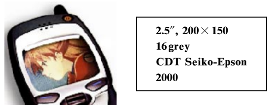
〈그림 9〉 고분자 소재를 이용한 능동구동 디스플레이
