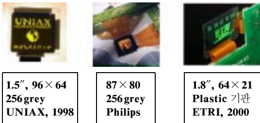
〈그림 8〉 고분자 소재를 이용한 수동 구동 디스플레이
