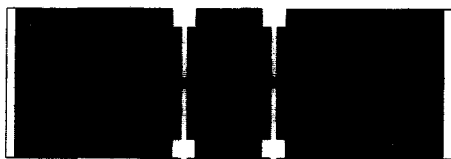
그림 2. 게이트 전극 형성을 위해 사용한 photo mask Fig 2. Photo mask for gate electrode formation
