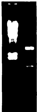
[그림 7] OPAA 유전자 절편 확인: pBlueOPAA를 Xho I/EcoR I 으로 절단 한 후 1% Agarose Gel 에서 전기영동 lane 1: marker DNA lane 2: OPAA 유전자절편 ← 1471 bp
