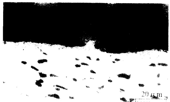
Fig. 15 알루미늄 주물과 철계 밸브 시트링이 성공적으로 저항접합된 경우의 단면.
