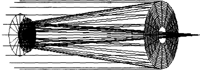
그림 5. 표 1에 기초한 solid model 분석, 주경에서 초점면까지의 거리는 53mm이고, exit pupil diameter는 20mm이다(ZEMAX-XE 사용).
