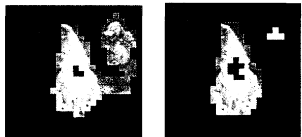
(a) 자기상관 처리 후 ( T_{cross} = 8/pixel , 3 \leq |X| \leq 5 , Y=0 에서 탐색) (b) 상호상관 처리 후 ( k_1 = 2.6 , |X| \leq 2 , Y=0 의 평균에서 \alpha 를 계산)
