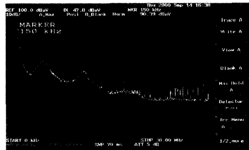
그림 19 LPF의 경우의 스펙트럼 파형 (Frequency range: 2Hz~30MHz, 10dB/div) Fig. 19 Spectrum results of conducted EMI (Frequency range: 2Hz~30MHz, 10dB/div)
