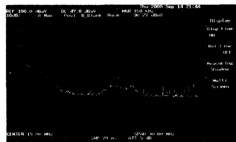
그림 20 Output filter 스펙트럼 파형 (Frequency range: 2Hz~30MHz, 10dB/div) Fig. 20 Spectrum results of conducted EMI (Frequency range: 2Hz~30MHz, 10dB/div)
