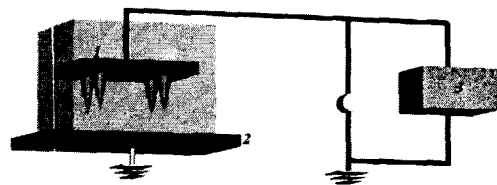
그림 1. 고전계를 이용한 분말 살균 실험장치
