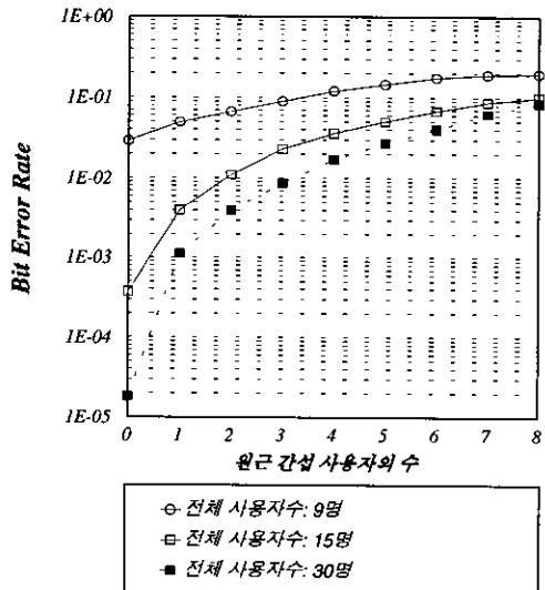
그림 8. 원근 간섭 사용자 수에 따른 DS-CDMA 시스템에서의 SCCDC의 BER 성능
