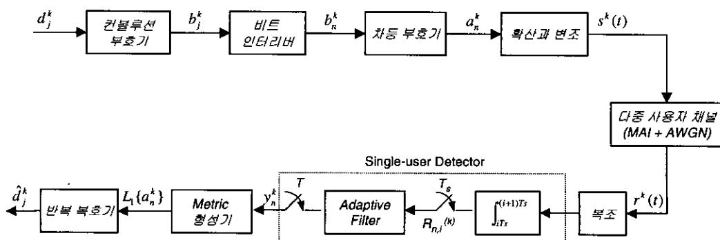
그림 1. DS-CDMA 시스템 구조
