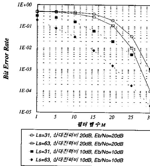
그림 7. 필터 템 개수에 따른 DS-CDMA 시스템에서의 SCCDC의 BER 성능
