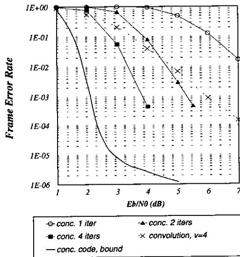
그림 5. DS-CDMA 시스템에서의 SCCDC와 Convolution 부호의 FER 성능
