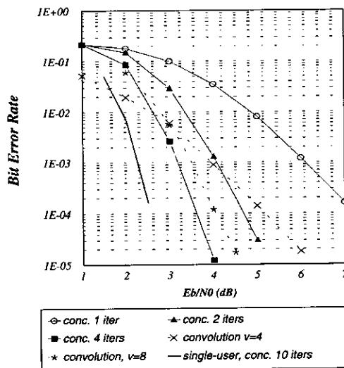
그림 4. DS-CDMA 시스템에서의 SCCDC와 Convolution 부호의 BER 성능
