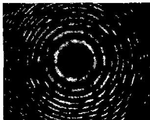
그림 2. 삼각간섭계에서 구한 간섭패턴 Fig. 2. Interference pattern obtained from the triangular interferometer
