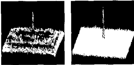
그림 9. (a) 바이어스가 존재하는 홀로그램에서 광학적으로 복원된 영상 (b) 바이어스가 제거된 홀로그램에서 광학적으로 복원된 영상.
