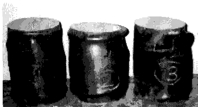
〈그림 14〉 CSC3 시험체 파괴현황
