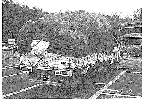
<사진 5> 과적한 채 뒷바퀴 한쪽타이어가 펑크나 차가 기울어져 있음
