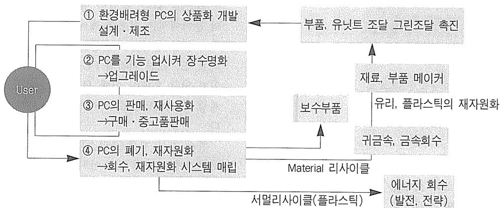
③ 소비자의 사용단계 ④ 사용종료제품의 회수 및 리사이클의 4단계를 거치도록 하고 있다. 여기서 T-LCA란 제품 재자원화의 라이프사이클을 고려해 자재조달에서부터 생산·사용·폐기의 4단계를 거치는 방법으로 일본전기(주) PC 개발상의 용어이다.(그림2)
