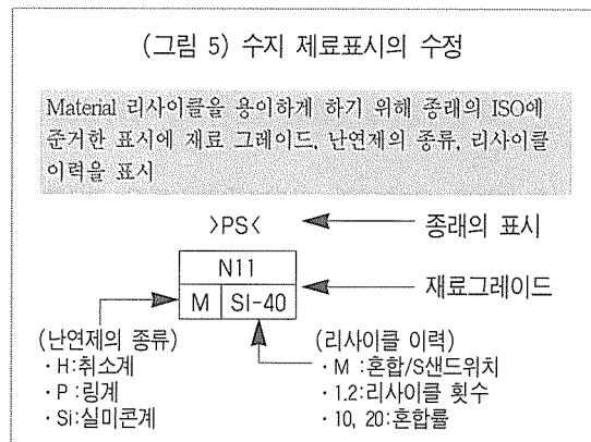
'92년부터 세계에 통용되는 ISO 준거 재료표시를 채용해 사용종료 PC의 회수시에 리사이클을 행하기 쉽도록 도모해 왔는바, material 리사이클 이력을 검토시 시판 및 자사의 재생 플라스틱을 사용하면서 현재의 재료표시를 (그림 5)와 같이 수정하였다.
