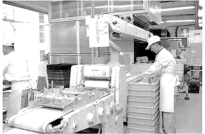
▲ 성심당 공장 내부. 이곳은 반죽 및 성형 기계를 이용해 반자동화 시스템으로 제품을 생산하고 있다.
