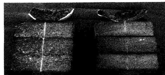
〈Photo 2〉 회전침식후 절단면 사진(좌: 개발품, 우: 외산품)
