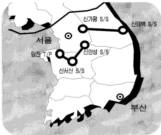
〈그림 2〉 765kV 송전선 및 변전소(1단계)
