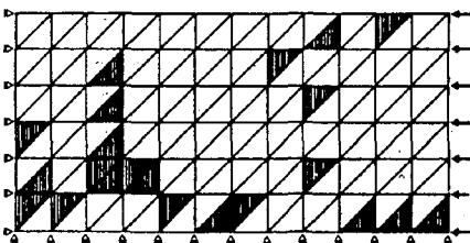
그림 6. 압축시험편 모델에 대한 탄소성 해석 결과 (1회 변위증분량 : 0.005 mm).
