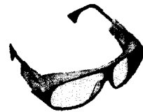
그림 20. Nd:YAG레이저에 대해 2kW까지 견딜 수 있도록 설계된 다층의 poly-carbonate 보안경
