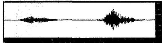
그림 20. 동시통화시 반향신호 + 근단화자의 음성 + 근단화자의 배경잡음 Fig. 20. Echo signal in case of double-talk + Voice of near-end speaker + Background noise of near-end speaker.
