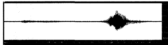
그림 21. 동시통화시 반향을 제거한 후의 신호 Fig. 21. The echo cancelled signal in case of double-talk.
