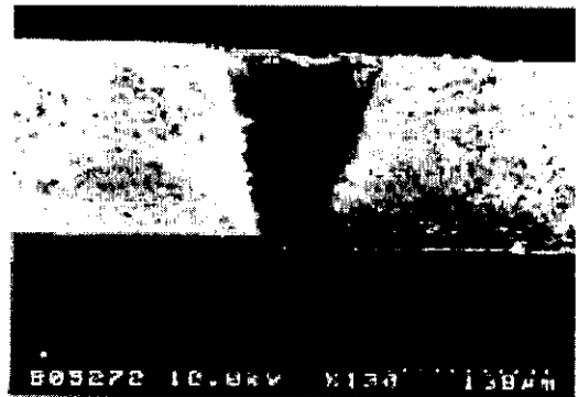
그림 10. Ar + laser( \lambda = 514 \text{ nm} )에 의한 PDP 격벽 시료의 식각된 단면의 주사전자현미경 사진 (건조시료, 레이저 출력 밀도 = 32 MW/cm 2 , 빔 주사 속도 = 200 \mu\text{m/s} ).
