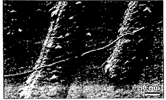
그림 7. SWNT가 두 백금전극과 연결되어 있는 모습. 좌 상단의 전극은 gate로 사용됨. Fig. 7. A SWNT is connected to two Pt electrodes. The upper-left electrode is used as a gate.
