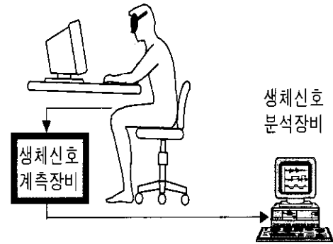
그림 1. VR 입체영상 제시 및 생체신호 측정 시스템 Fig.1. System Configuration
