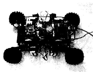
(주) 로보블럭시스템에서 일본의 3D사와 공동으로 제작한 로보돌이(robodori)는 국내외 초소형 프로그램 어블 디지털 완구 로봇이다. 로보돌이는 [5]작은 크기 이기 때문에 손안에 들어오고, 귀여운 캐릭터로 악세사리로 이용 가능하게 설계되어 있다. 또한, 언제, 어느 곳에서나 로봇 경기대회를 할 수 있다. 물론, 로봇의 동작 형태를 프로그램어블 리모콘으로 제어할 수 있게 설계되어 있기 때문에 직접 로봇의 동작 형태를 제어할 수 있다. 로봇 경기대회를 즐길 수 있는 게임은 로봇에 장착된 센서를 이용하여 즐길 수 있다. 즉, 씨름 경기 놀이, 라인 따라가기 놀이, 사다리 타기 놀이, 미로찾기 놀이, 소형 로봇 오케스트라 놀이 등이 가능하다.
