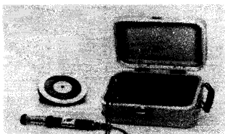
그림 7(b) 가이드 링을 이용한 분극 저항 측정 장치 예
