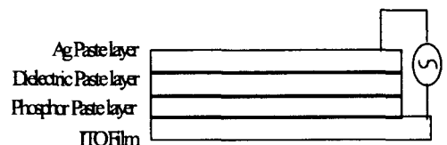
그림 1. EL 소자 구조 Fig. 1. The structure of EL device
