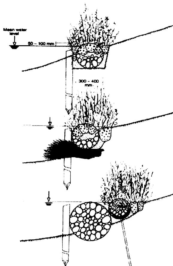
그림 5.2 를 갈대 설치 모식도
