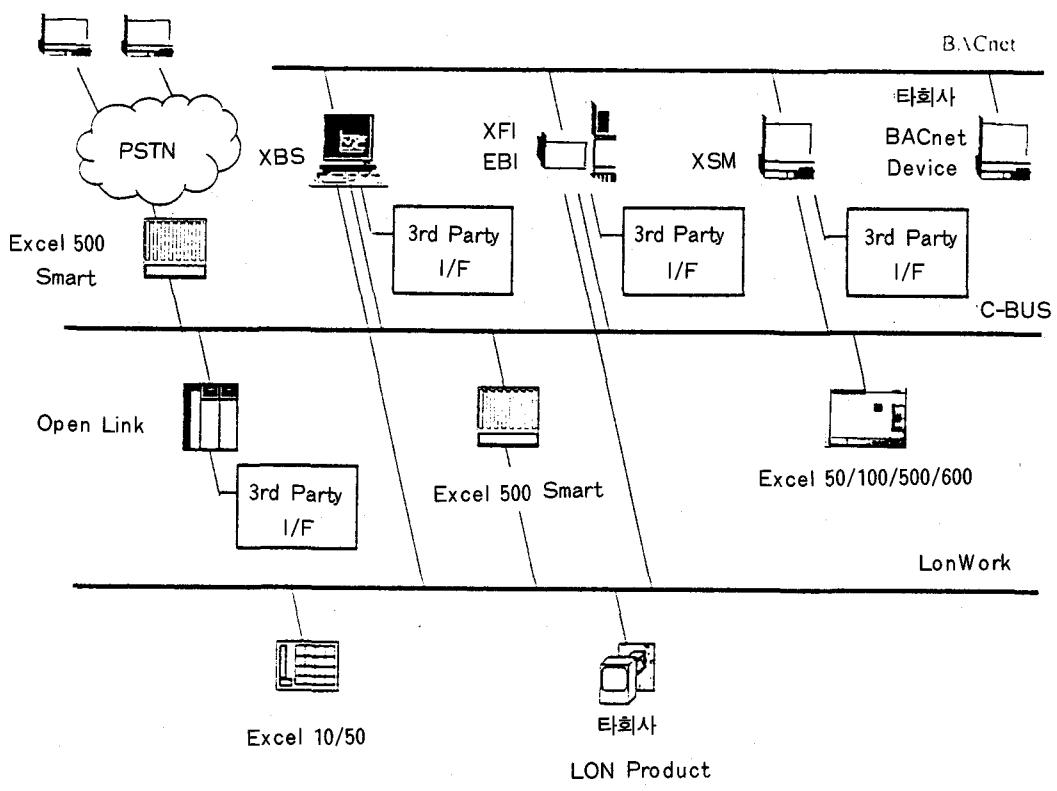
다. 따라서, 자동제어 통신 표준을 채택하지 않는 제품과의 통합이 필요한 경우 또는, 기존 시스템을 확장하거나 기존 시스템과의 통합이 필요한 경우에 연결성(Connectivity) 기술이 활용되어야 한다. 개방성을 제공하지 못하는 시스템과의 통합을 위해 하나웰이 채택하고 있는 최근의 연결성(Connectivity) 기술은 시스템간의 상호 인터페이스를 가능하게 하며, 어느 정도는 상호 운용성을 가지고 있다. EXCEL 5000 제품군은 여러가지 연결성 기술을 채택하여, 다양한 수준의 통합을 추구하고 있다. Management 계층에서의 통합은 OLE, Network DDE, DDE, OPC를 통하여 허용된다. Automation 계층에서의 통합은 EBI, XFI, XBS, XSM 시스템과의
