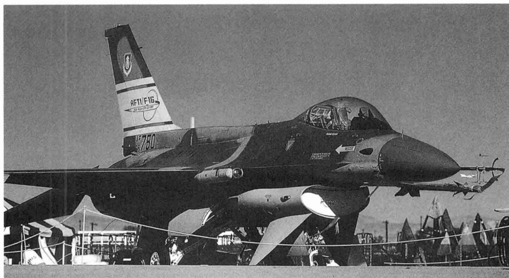
CCV 기술시험을 위해 Canard와 Dorsal Spine를 장착 개조한 General Dynamics F-16(AFTI/F-16)
