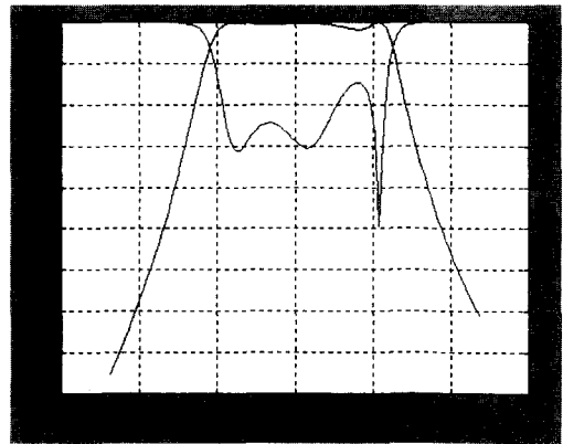
그림 11. 최적화 설계된 수신필터의 Full-wave 응답특성 Fig. 11. Full-wave response of the Rx filter after the optimization.
