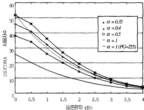
그림 4. 전력제어 오차에 따른 DS/CDMA 가입자 용량 : PG = 128,  $(E_b/N_o)_{\min} = 7 \text{ dB}$
