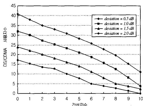
그림 5. 전력제어 오차에 따른 DS/CDMA 가입자 용량 : PG = 128, m = 1,  $(E_b/N_o)_{\min} = 7 \text{ dB}$ , R = 2,  $\alpha = 0.4$ ,  $\sigma_{shad} = 8 \text{ dB}$ .
